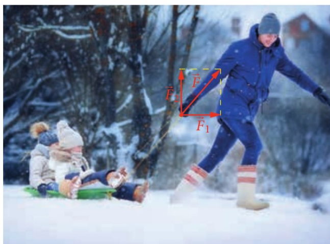
\vec{F} – siła, z jaką ciągnięte są sanki, \vec{F}_1 – składowa pozioma siły \vec{F} , która wykonuje pracę równą W = F_1 \cdot s , \vec{F}_2 – składowa pionowa siły \vec{F} , powoduje tylko zmniejszenie nacisku wywieranego przez sanki na śnieg.
